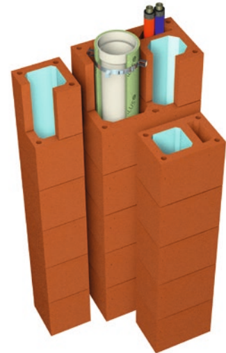
Abb.5: Gleich drei verschiedene Lüftungsschächte bietet ERLUS bei ViaVento an: den einzügigen Lüftungsschacht Vento (li), den Vento+i mit Installationsschacht für Solarthermie, und den Triva Vento (hinten) mit LAF-Schornstein für Kamin- und Kachelöfen sowie dem Installationsschacht für Solarthermie.
