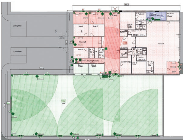
Digital lassen sich die Überwachungsbereiche visuell deutlich darstellen.
