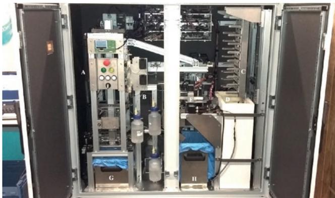
Abb. 1: LEGIOLAB® besteht aus: A) Filtermodul, B) Elutions- und Waschzone, C) Reagenzienkartusche, D) Kühltschrank, E) Analytikmodul, F) Teleskopklader, G) Behälter für verbrauchte Filter, H) Behälter für verbrauchte Kartuschen, I) Bedienfeld.
