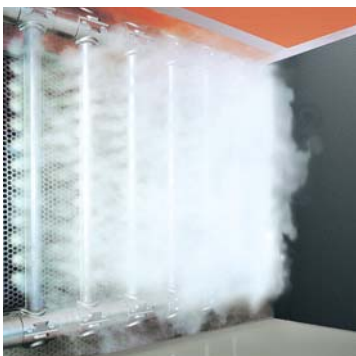
Abb.5 Mehrfach-Dampfverteilssysteme wie Condair OptiSorp verteilen den Dampf gleichmäßig über den gesamten Luftstrom und ermöglichen dadurch sehr kurze Befeuchtungsstrecken
