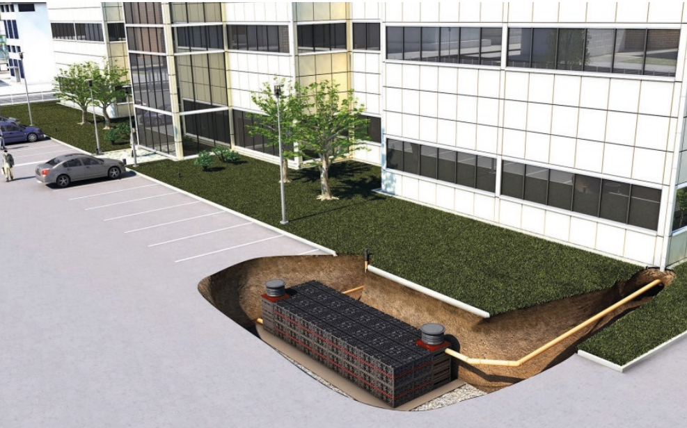
Abb. 1: Vor allem im urbanen Umfeld wirken Rigolensysteme der Flächenversiegelung entgegen
