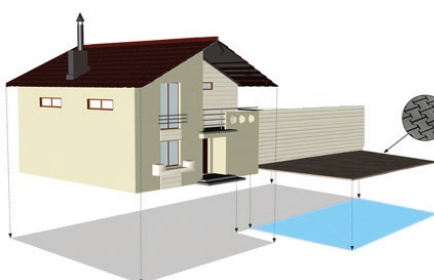
Abb. 4: Bei der Bestimmung der Einzugsgebietsflächen sind lediglich die projizierten Flächen relevant.
