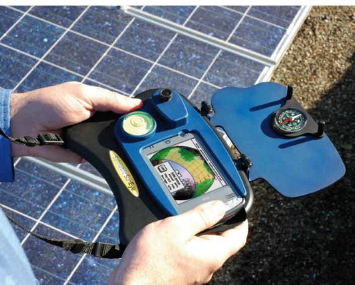
Abb.4: Schattenanalysator SunEye im Einsatz vor Ort
