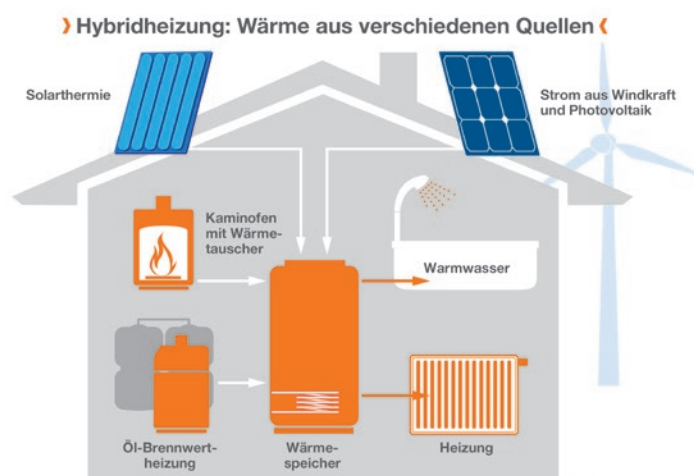
Ein Hybridsystem kombiniert die Vorteile verschiedener Energieträger wie Heizöl, Holz oder Sonnenwärme. Künftig könnte mit Power-to-Heat zusätzlich auch überschüssiger Strom aus erneuerbaren Quellen genutzt werden.
