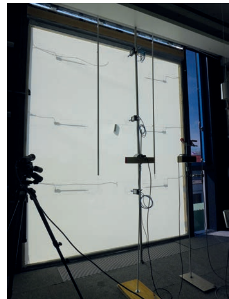
Abb.3, rechts: Innenansicht Mockup-Fassade bei vollständig geschlossenem Sonnenschutz-Screen und mit Temperaturmessbaum für die Komfortbewertung
