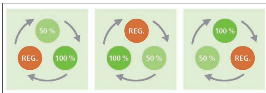
Abb.4 Funktionsprinzip der Dreifach-Enthärtung
