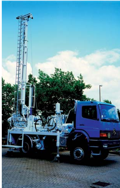
Bohrplatz für eine Erdwärmesonde. Werkfoto Waterkotte
