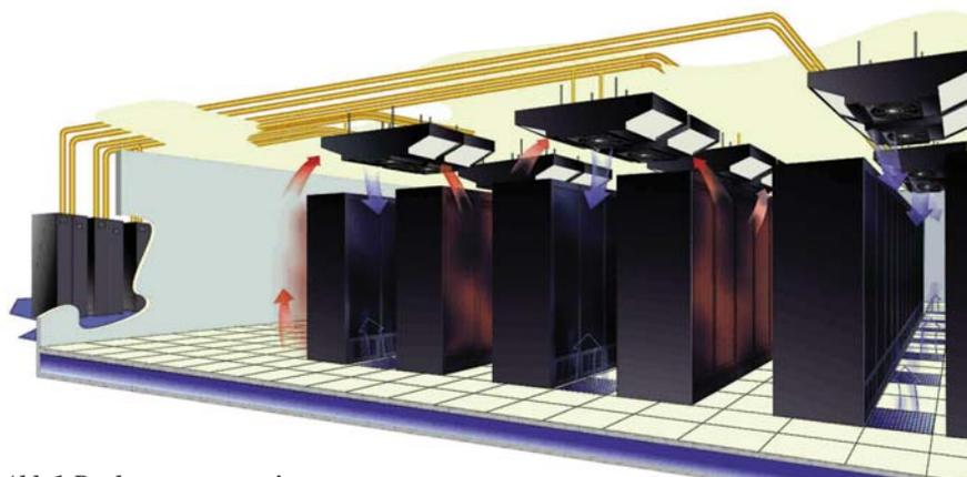
Abb.1 Rechenzentrum mit deckenmontierten Kühlmodulen Liebert XDO
