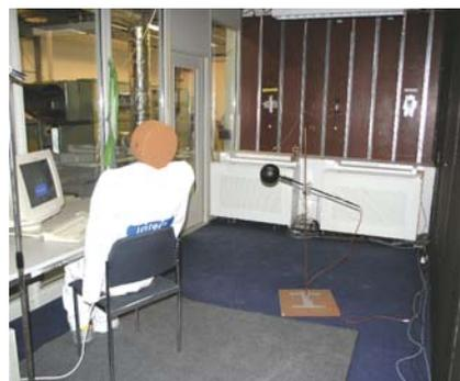
Abb.5 Versuchsraum im Imtech-Labor mit temperierbarer Fassade (Maßstab 1:1)
