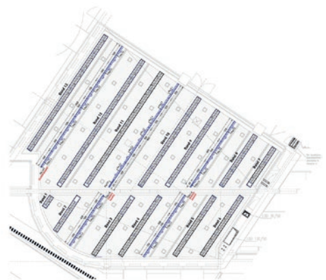
INDUCOOL Anordnung in Bandmontage für eine anspruchsvolle Raumgeometrie
