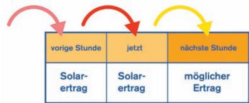
Abb.1 Eine patentierte Rechnerlogik errechnet Solarerträge im Voraus, verhindert die Nachheizung und ermöglicht so höhere Solarerträge.
