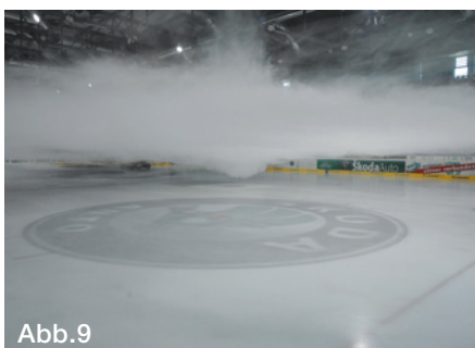
Abb. 5-10 v.l.: Die Temperaturen auf dem Eis liegen bei optimalen Kältetemperaturen, während die Zuschauer auf den Rängen keineswegs frieren müssen. Die Kaltluftschicht auf dem Eis (Abb. 10) bleibt bei dieser Konzeption ungestört.
