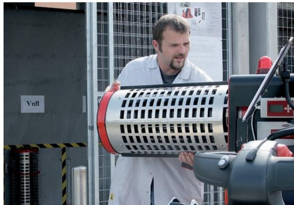
Abb.2: Rasche Fahrzeugbetankung durch Kartuschenwechsel
