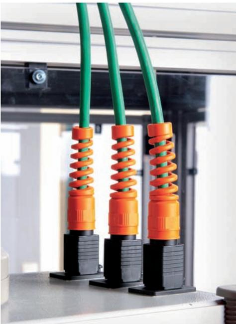
Geschützter Maschinenanschluss in genormter Variante 4
