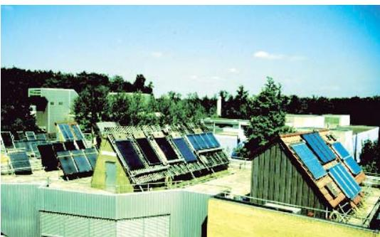
Abb.2 Das Institut für Thermodynamik und Wärmetechnik in Stuttgart prüft Komponenten für solarthermische Anlagen in Dauer-Prüfverfahren auf Eignung für die den zugrunde gelegten Normen entsprechende Anwendbarkeit
