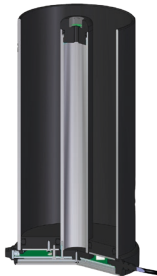
Die Feuchtwage Wöhler FW 550 misst die Kapazität des Brennstoffes. Mit der im Boden integrierten Waage bestimmt sie außerdem die Gesamtmasse der Messprobe. Daraus berechnen das Messgerät oder die PC-Software automatisch die korrekte Schüttdichte.
