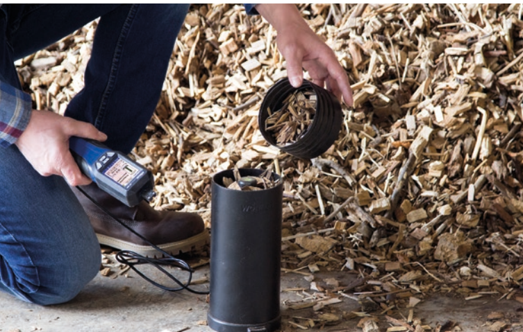
Bereits wenige Sekunden nach dem Befüllen der Feuchtwage Wöhler FW 550 mit der Messprobe lässt sich der Feuchtwert im Display des Holzfeuchtemessgerätes ablesen.
