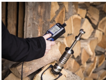
Zur Bestimmung des Feuchtegehalts von Scheitholz über eine Widerstandsmessung wird die stabile Einschlagsonde an das Messgerät Wöhler HF 550 angeschlossen. Deren Messelektroden können tief in den Holzscheit eingedrungen werden.
