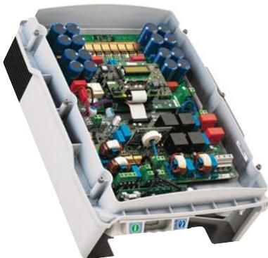
Abb.1 Hightech-Innenleben eines modernen Solarwechselrichters (SMC 8000 TL + ESS)
