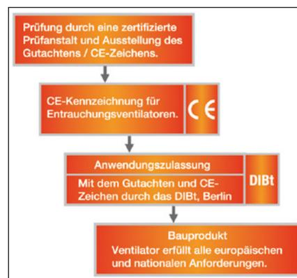
Abb. 7: Bauaufsichtliche Anforderungen an Entrauchungsventilatoren
