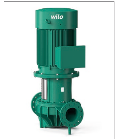
Die „Wilo-CronoLine-IL“ ist eine einstufige Niederdruck Kreiselpumpe in Inline Bauart. Hochwertige Werkstoffe und das patentierte Laternendesign für die optimale Ableitung von Kondensat sichern trotz Dauerbelastung einen langen Lebenszyklus. (Foto: Wilo)
