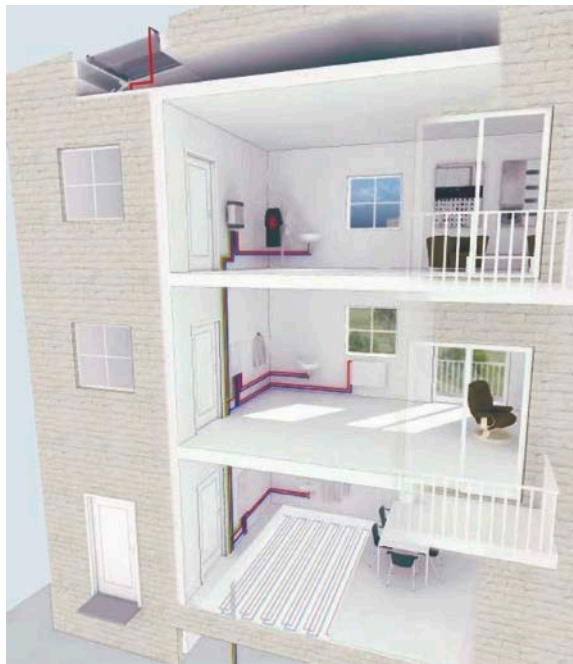
Abb.4: Dezentrale Wohnungsstationen bieten eine Alternative zur traditionellen energetischen Versorgung in Gebäuden.
