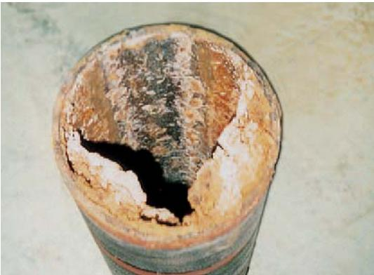
Abb. 3 Rohrverstopfung durch ausgehärtete Fette
