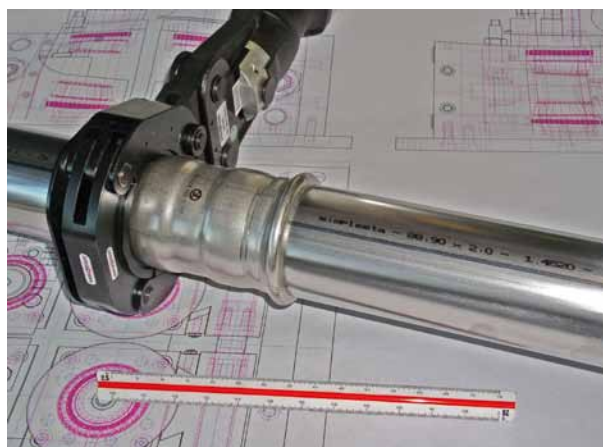
Abb. 1: Edelstahlrohr aus Werkstoff 1.4520 für Heizung und andere geschlossene Wasserkreisläufe; speziell angepasster Pressverbinder mit Piktogramm „kein Trinkwasser“
