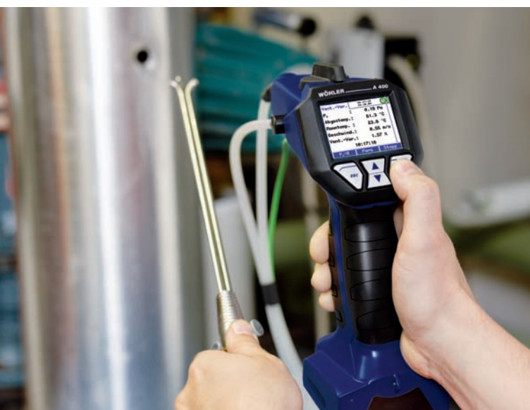
Abb.1: Einsatz des Messgerätes Wöhler A 400 zur Ventilationsmessung
