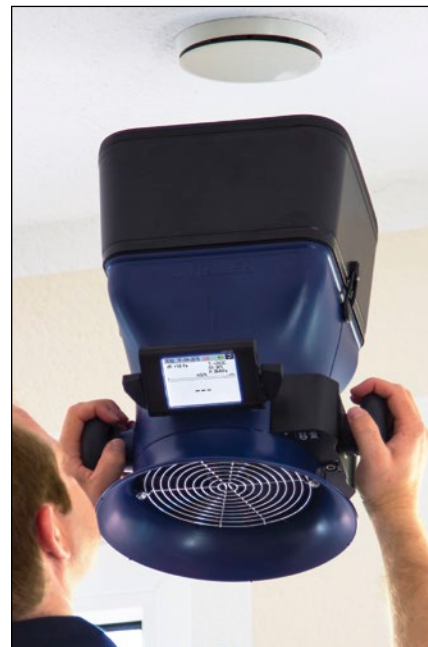
Abb. 6: Wöhler CFM 600 Messgerät mit Kompensationsverfahren
