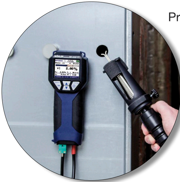
Abb.1: Messung an einer eckigen Luftleitung in verschiedenen Ebenen mit dem Wöhler DC 410 Flow
