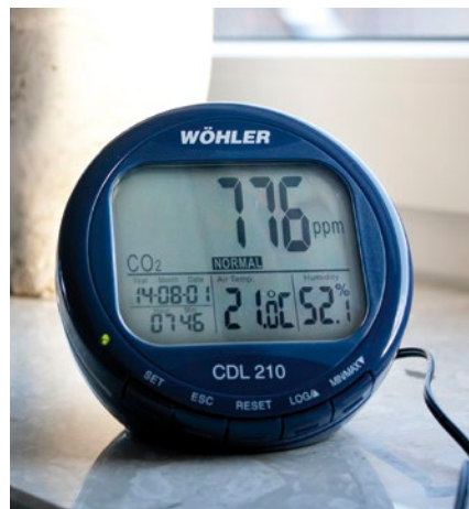
Abb.9: Raumluftqualität-Kombinationsmessgerät mit Datenloggerfunktion
