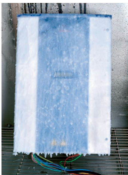
Abb.3 Wechselrichter Powador mit Eiszapfen. Klimawechseltests garantieren eine hohe Lebensdauer.
