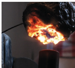
Abb. 2: Brandschutzfarbe im Versuch
