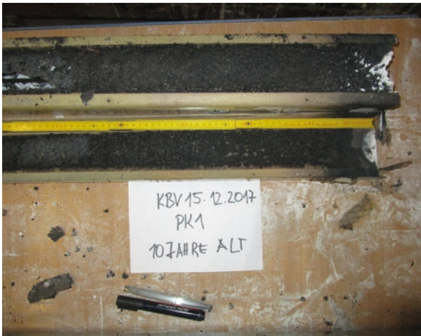
Abb. 5: 10 Jahre alter Installationskanal PYROMENT IK 90 von G+H nach Brandprüfung mit unverändertem Aufschäumverhalten
