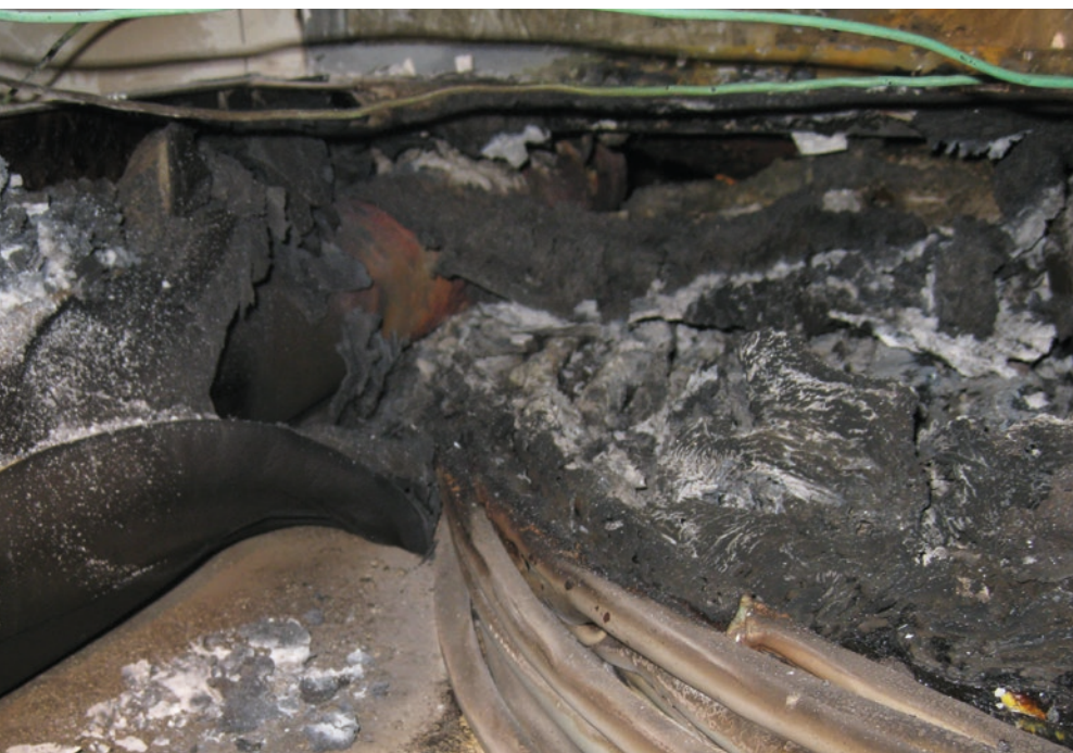
Abb. 1: Installationskanal PYROMENT IK 90 nach Brandversuch auf der Luftseite unmittelbar hinter der Wanddurchführung
