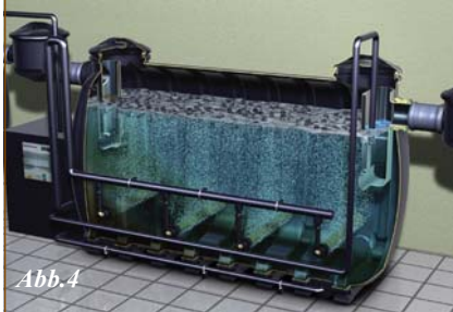
Abb.2 BIFENA BF2, Fettabscheider Nachbehandlung
