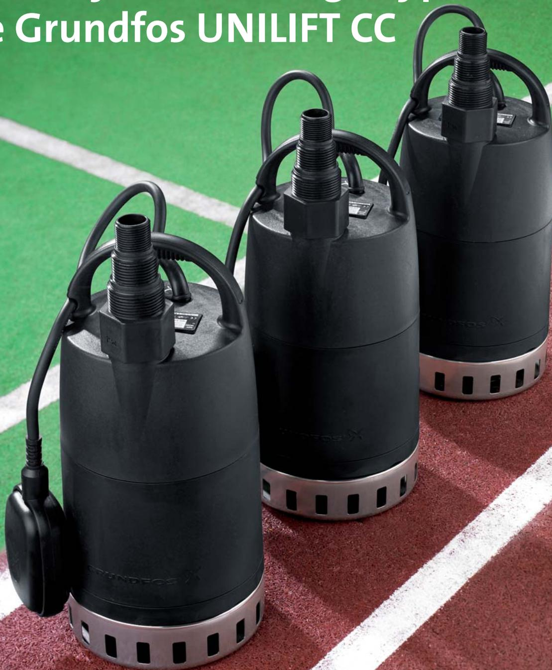
Mit Grundfos UNILIFT CC kommen bei der Entwässerung ganz neue Qualitäten ins Spiel. Der perfekte Ausputzer brilliert durch einzigartige Flachabsaugung bis auf 3 mm Höhe, gilt als wahres Konditionswunder und ist durch das robuste Gehäuse (Kunststoff/Edelstahl), Entlüftungsautomatik und Kühlmantel kaum zu stoppen. Die UNILIFT CC ist die Erste mit keramischem Doppeldichtungssystem plus Lippendichtung und arbeitet über und unter Wasser, mobil und stationär.
