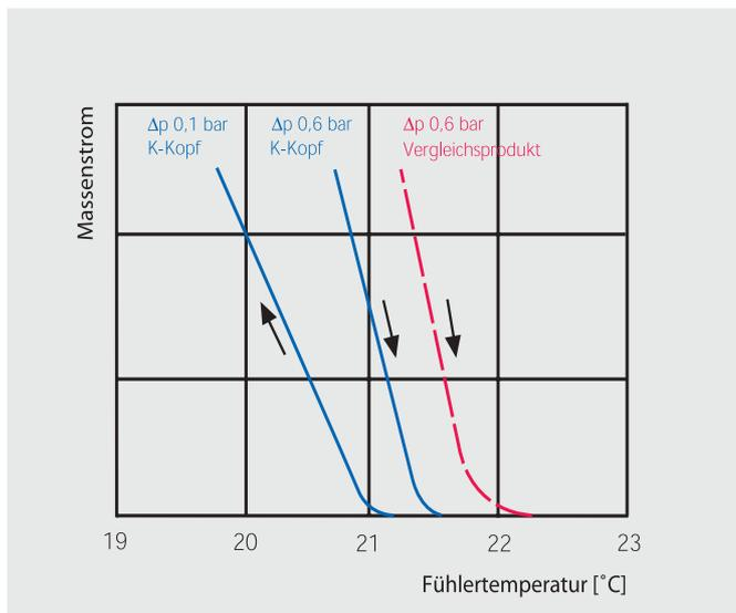
Abb. 9 Darstellung des Differenzdruckeinflusses auf die Schließtemperatur bei  $\Delta p = 0,6$  bar entsprechend EN 215. Ein derart hoher Anstieg des Differenzdruckes beim Schließvorgang ist in der Praxis normalerweise nicht zu erwarten. Deutlich wird jedoch die Überlegenheit des K-Kopfes gegenüber Thermostat-Köpfen mit kompressibler Fühlerfüllung. Denn ein rechtzeitiges deutliches Schließen bringt zusätzliche Energieeinsparung
