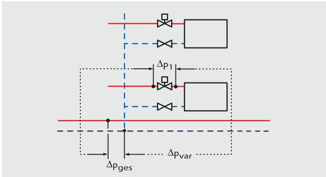
Abb.6 Bezugsdifferenzdruck Anlagenabschnitt  $\Delta p_{ges}$ , bei großen Anlagen
