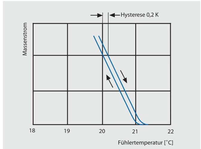
Abb.7 Hysterese eines Thermostatventils mit Thermostat-Kopf K, dargestellt als Temperaturdifferenz zwischen Öffnungs- und Schließkennlinie bei 1 K Auslegungsregeldifferenz und  $\Delta p = 0,1$  bar, Labormessung (Heimeier)
