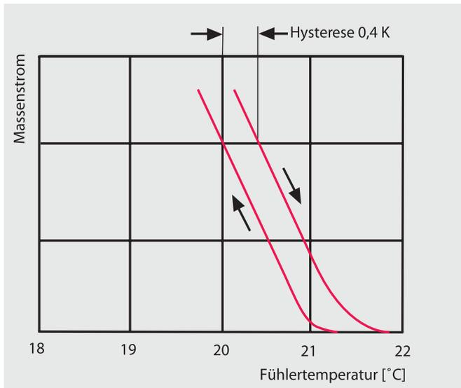
Abb. 8 Hysterese eines Thermostatventiles mit Thermostat-Kopf mit kompressibler Füllung, dargestellt als Temperaturdifferenz zwischen Öffnungs- und Schließkennlinie bei 1 K Auslegungsregeldifferenz und  $\Delta p = 0,1$  bar, Labormessung eines Vergleichsprodukts. Deutlich wird die um 100% vergrößerte Abweichung gegenüber einem exakt regelnden Thermostatventil mit einer auf ein Minimum reduzierten Hysterese von 0,2 K (Heimeier)
